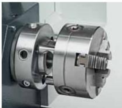
Зажим Camlock для быстрой смены патронов
