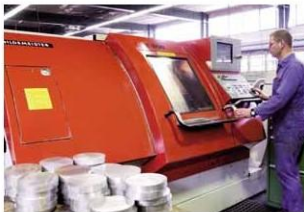
обрабатывающий центр с ЧПУ с вращающимися инструментами
