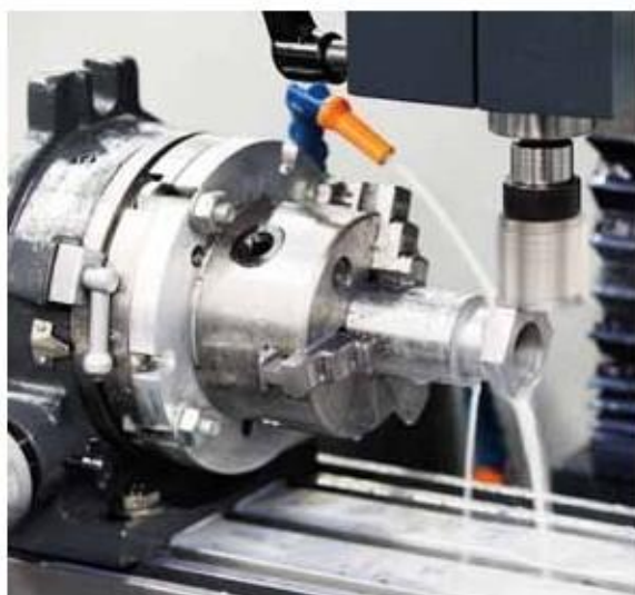
фрезерование шестигранника на поворотном столе, станок с ЧПУ, сталь 42CrMo4
