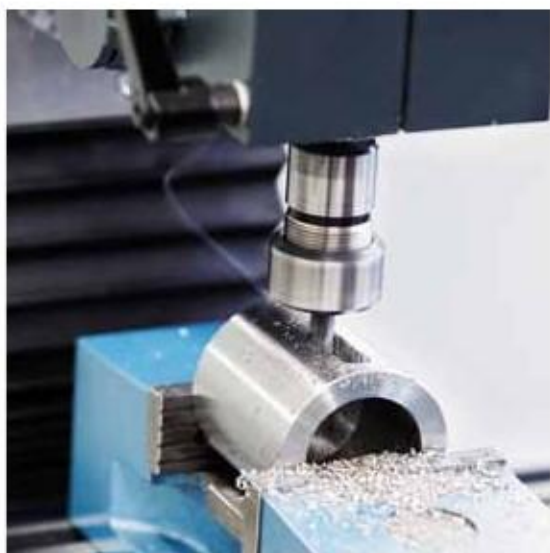
Фрезерование шпоночных канавок на стали 42CrMo4
