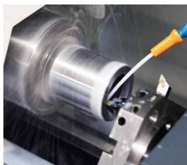
Растачивание стали 16 MnCr5
