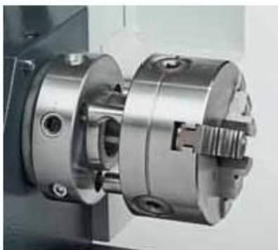
зажим Camlock для быстрой смены патронов
