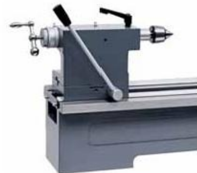
Задняя бабка с механизмом быстрого перемещения
