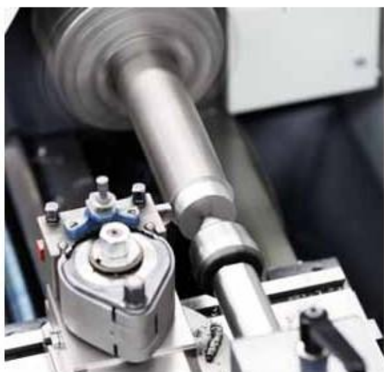
точение проходным резцом стали C45, черновая обработка
