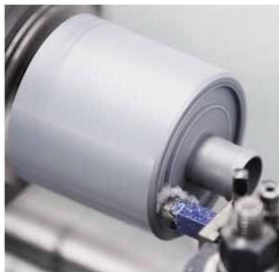
подрезка торцевой поверхности в ПВХ
