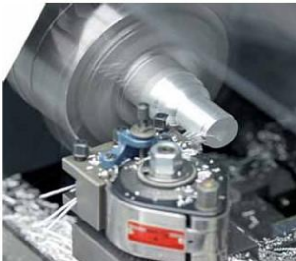
обтачивание алюминиевого болта AlCuMgPb проходным резцом
