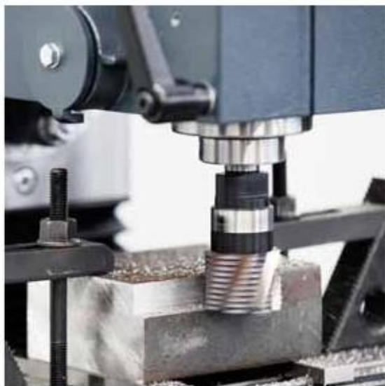
Черновая обработка стали St52,3 цилиндрическо-торцевой фрезой
