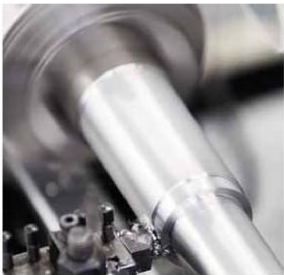
точение проходным упорным резцом, сталь С45
