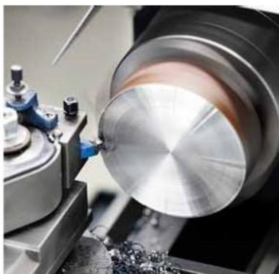
черновая подрезка стали 16MnCr5
