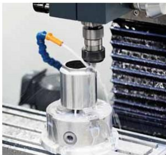
фрезерование шестигранника на трубке, сталь С45
