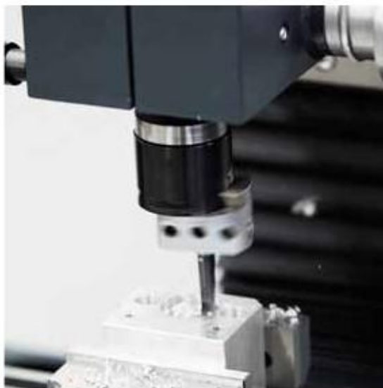
Растачивание алюминия AlCuMgPb расточной головкой
