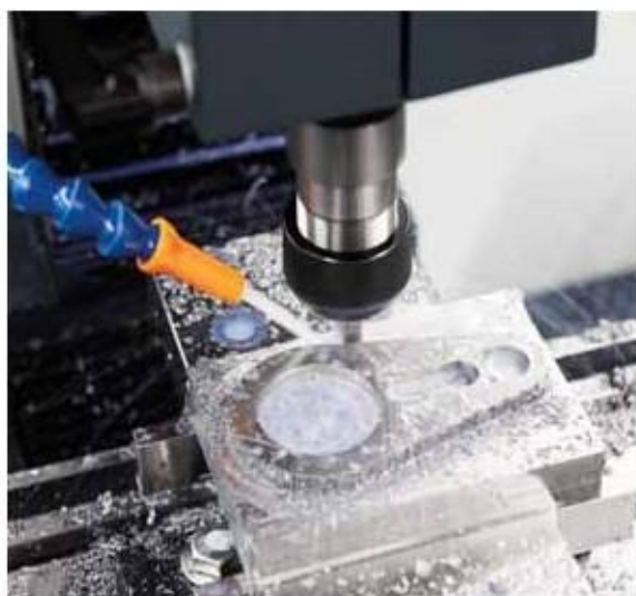
фрезерование фасонной поверхности, сталь 16MnCr5
