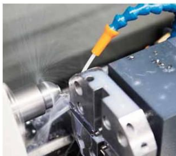
токарная обточка полусферы, высококачественная сталь 1.4301
