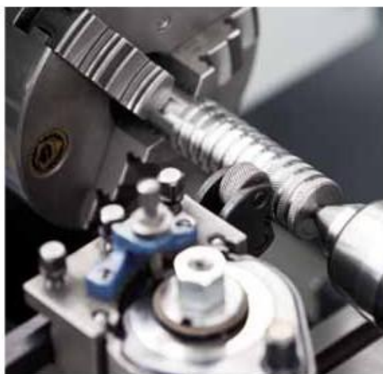
накатывание прямых рифлений на стали 9S28K
