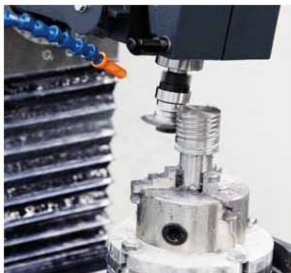
фрезерование двухзаходного шнека, сталь 9S28K
