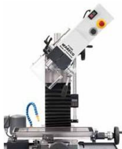
Фрезерная головка с поворотом на 45°
