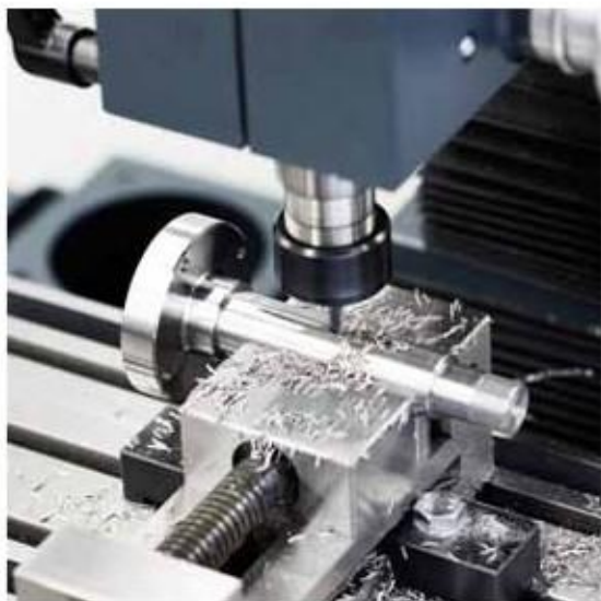
фрезерование канавок под призматическую шпонку на стали C45
