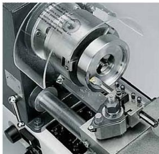
Растачивание стали С45
