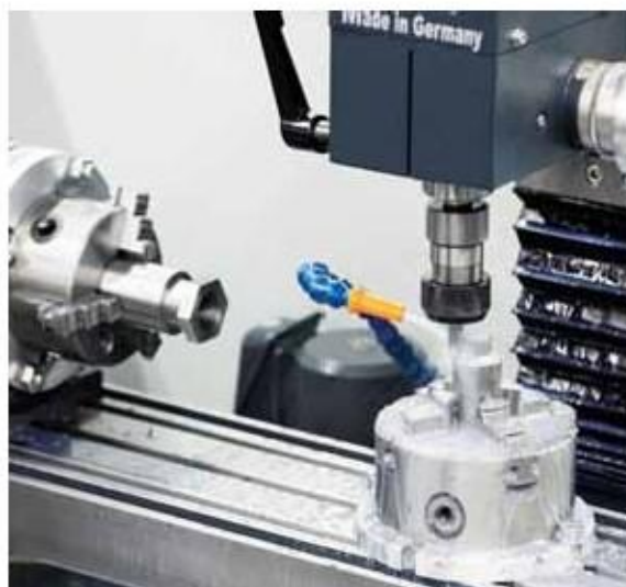
вертикальное фрезерование шестигранника, сталь 42CrMo4
