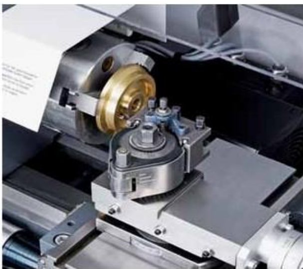
поперечная обточка бронзы Rg7
