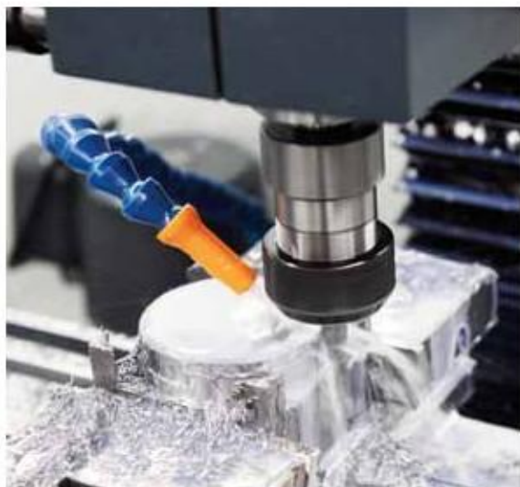
фрезерование внешнего контура стали С45
