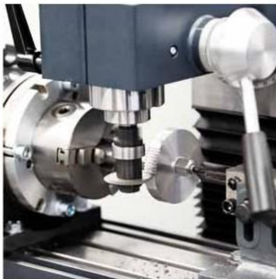
Фрезерование зубчатого колеса делительной головкой алюминий AlCuMgPb
