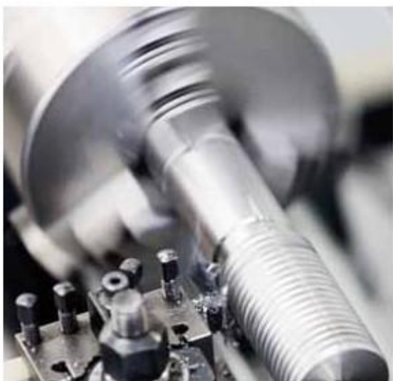
Нарезание наружной резьбы из высококачественной стали 1.4301
